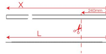
**5** Pegue la tira de LED en el fleje de acero, el inicio debe estar a 60 mm de un extremo del fleje de acero
