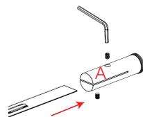
**7** Gire la base que esta pegada al muro manteniendo la parte de la tira LED en la orientación requerida
