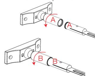
**8** Gire la parte A y parte B hasta obtener la tensión requerida y realice conexiones finales
