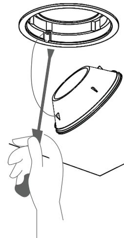
**5** Colocar el reflector secundario por abajo, para asegurarlo se genera presión hasta escuchar clic
