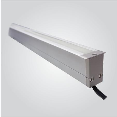
Luminaria lineal con tecnología LED para interior o exterior con alto brillo. Cuenta con un housing de extrusión de aluminio que permite la instalación en piso. El elemento iluminado está fabricado en silicón de alta resistencia que logra una difusión de la luz de forma uniforme. Requiere fuente de alimentación 24VD, remota.
