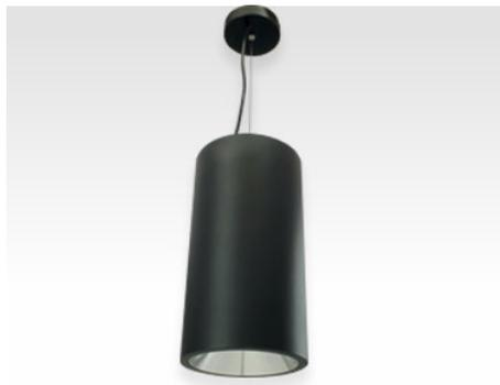
Luminaria de sobreponer cilíndrica para iluminación de acento fuente de luz LED COB con CRI 90, fabricada en aluminio con recubrimiento de pintura de resina poliéster en polvo aplicada mediante proceso electrostático, cuenta con diferentes ángulos de apertura, acabados en reflectores y accesorios. Para uso interior.
